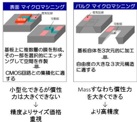
図2 表面型とバルク型の構造比較
