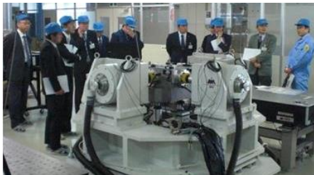
多軸慣性センサ、IMUの評価ツール 「6軸振動台」を実演紹介!
